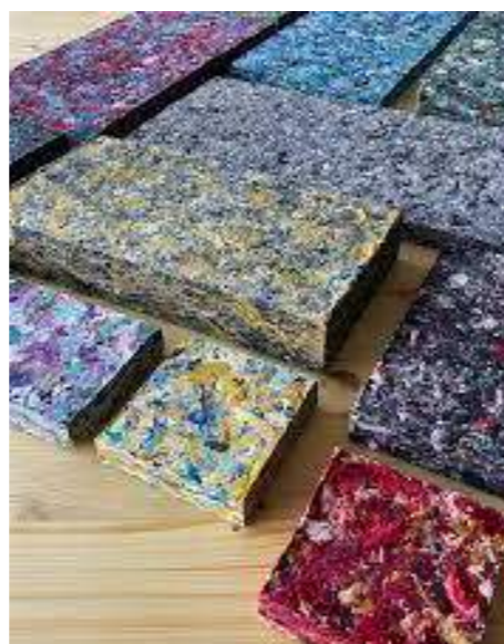
Briques faites à partir de textile recyclé puis broyé et pressé à l'aide d'anciennes presses à brique.
