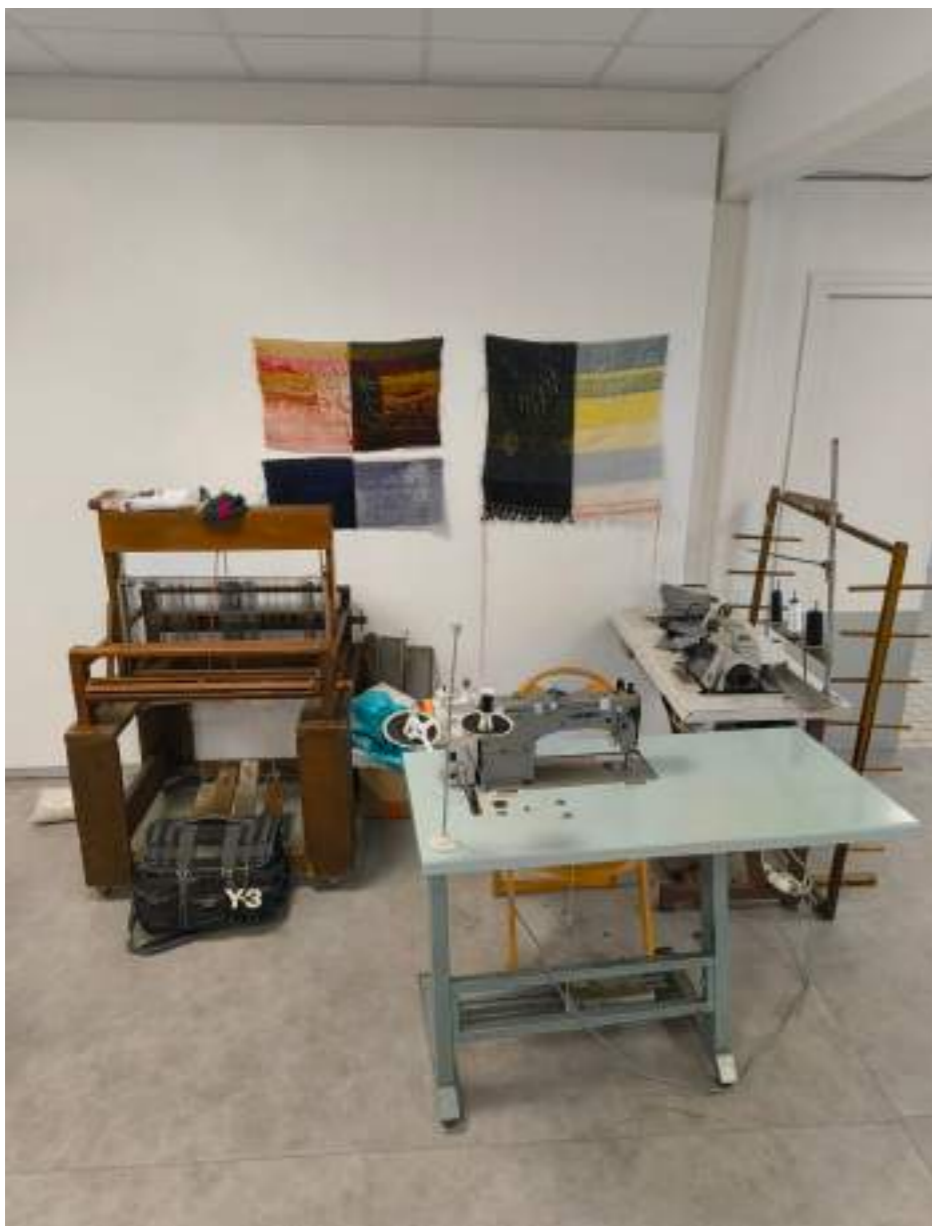
Mon espace de travail au sein de l'ESAD Orléans avec mes machines. Métier à tisser traditionnel 4 cadres, piqueuse à plat, surjeuteuse. Photographie, archive personnelle, novembre 2025
