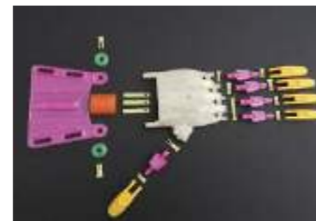
Main E-nable, chaque pièce peut être remplacée, réparée ou améliorée de manière individuelle. Cela permet une personnalisation ainsi qu'une maintenance ciblée.
